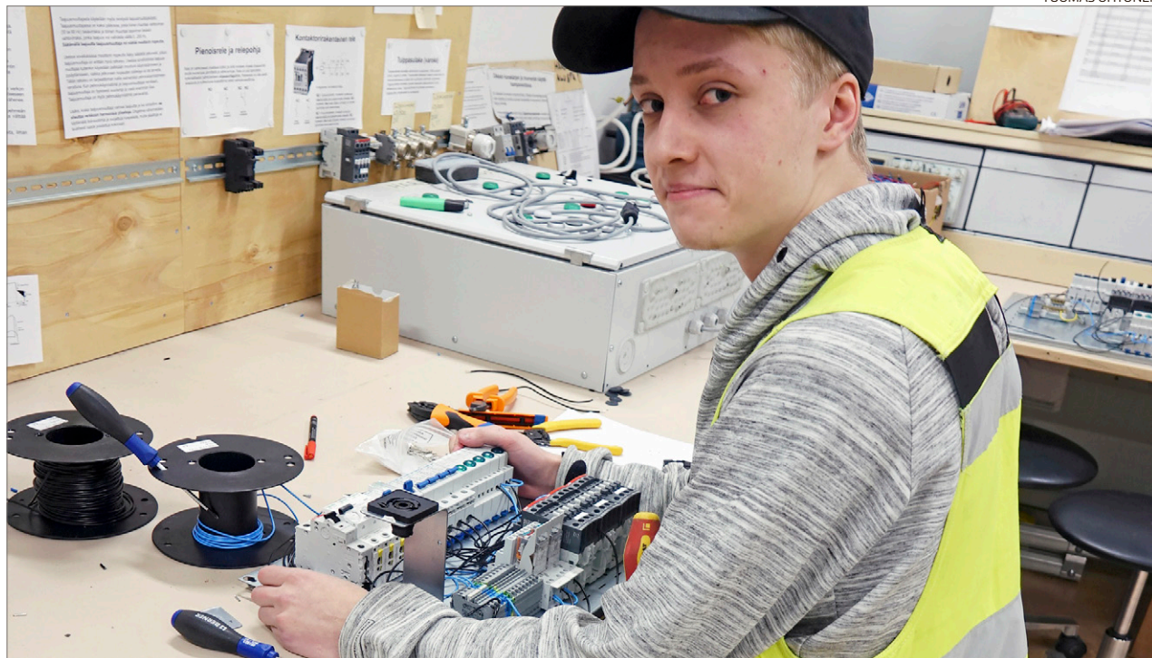
Kolmannen vuosikurssin opiskelija Teemu Kananen Lapinlahdelta asentaa lämminvesivaraajan vastuksien ohjausyksikköä.
